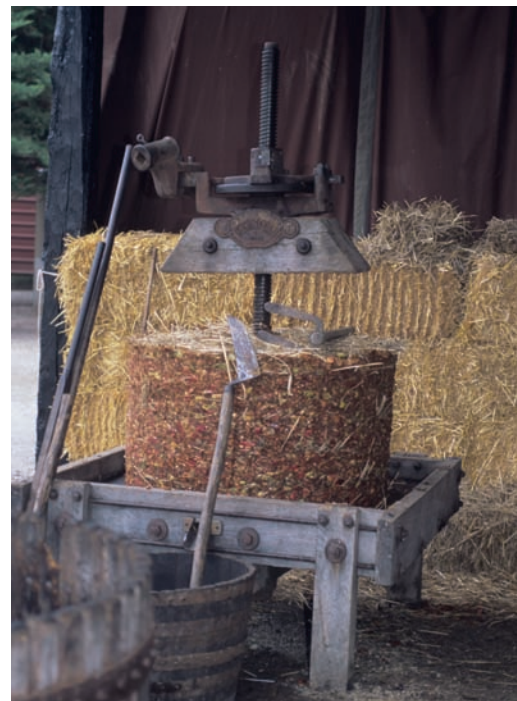
Le pressoir à cage et son marc (Coll. Ecomusée du pays de Rennes)
